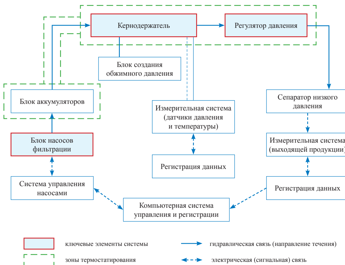
Рис. 1. Функциональная блок-схема экспериментальной установки двухфазной фильтрации
