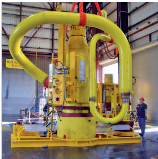
Рис. 2. Сепарационная установка проекта Perdido
