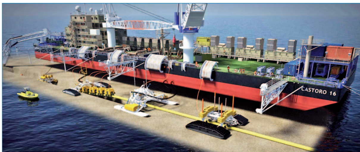
Рис. 2. Траншеекопательное оборудование баржи Castoro 16
