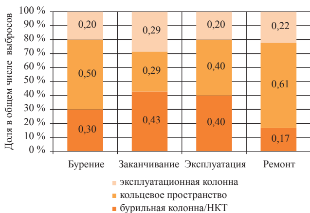
Рис. 6. Частота реализации путей выбросов из скважин: НКТ – насосно-компрессорные трубы
