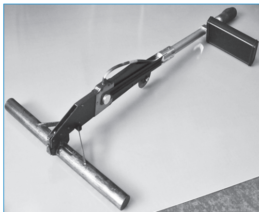
Рис. 3. Вихретоковый дефектоскоп ДНШ-24
