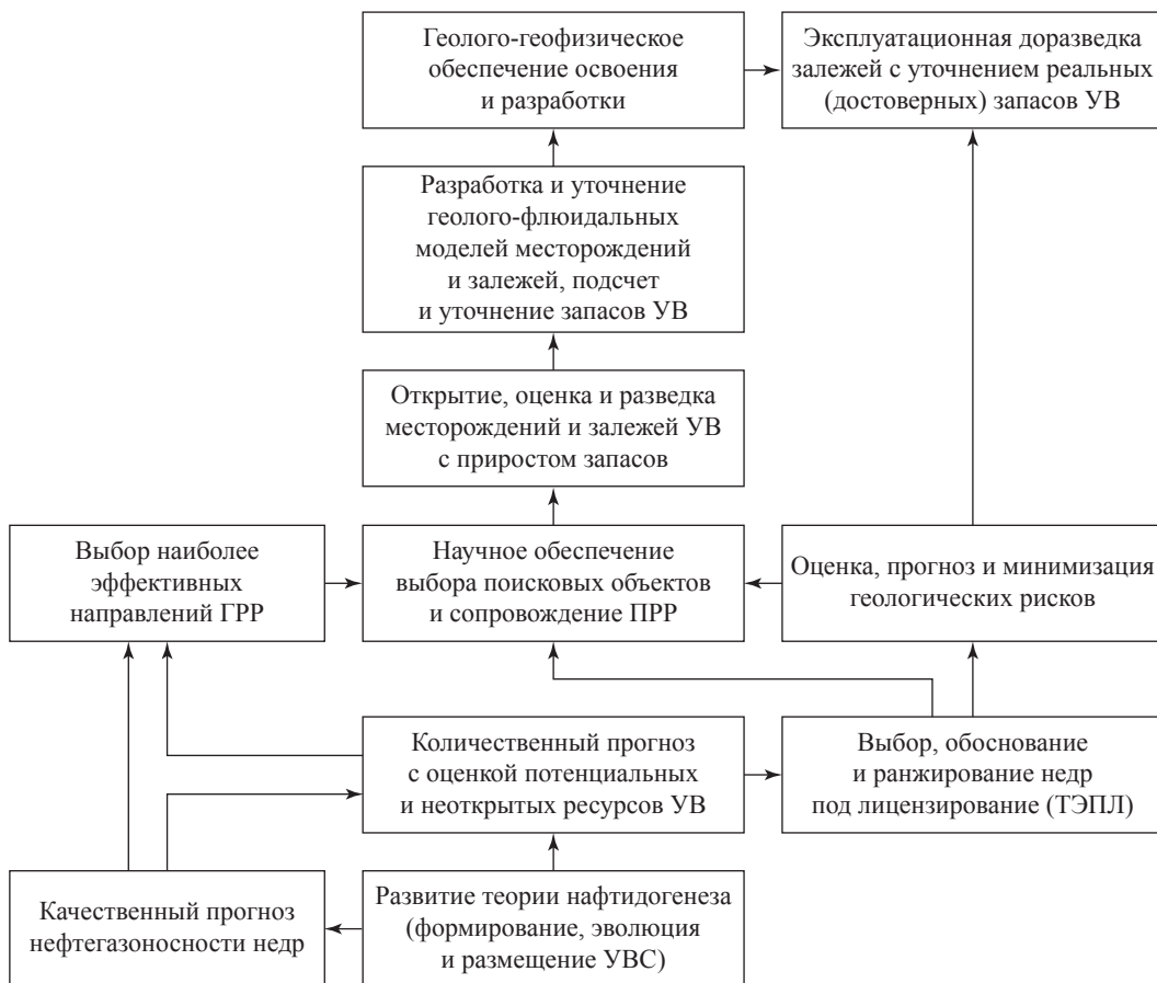
Последовательность действий в развитии нефтегазовой геологии, формировании и освоении МСБ добычи УВ: ГРП – геологоразведочные работы; ТЭПЛ – технико-экономические предложения по лицензированию; УВС – углеводородные скопления
