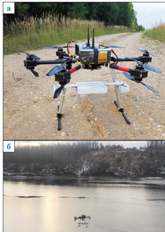
Рис. 5. Общий вид МБС-04 «СКИФ» на октокоптере 12Р-Ф (а) и сканирование подводных переходов газопровода АО «АЛРОСА-Газ» методом магнитной томографии (б)
